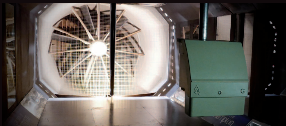
Essai de résistance en soufflerie jusqu'à 140 km/h – Soufflerie RG Mitchell, Université de Southampton
