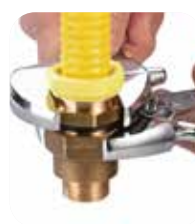
Serrer manuellement l'écrou pour bloquer le tuyau flexiPIPE Terminer le serrage en butée
